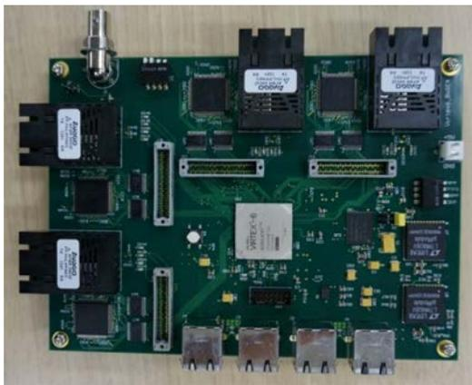
Fig. 3 FPGA を用いた畳み込み装置
