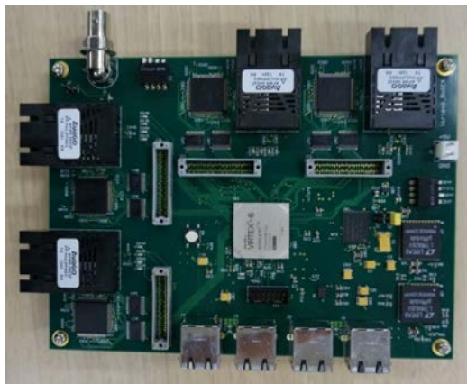
Fig. 3 FPGA を用いた畳み込み装置
