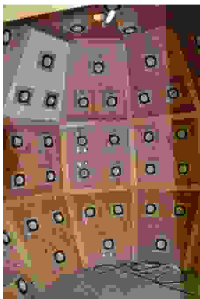
写真3 音響樽内部のスピーカ配置
